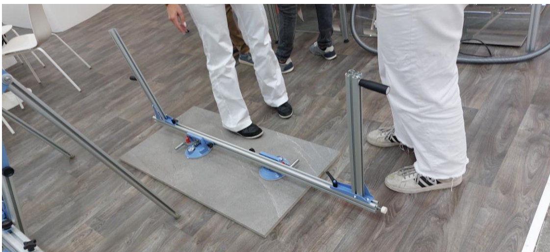
- manipulační přípravek, který umožní manipulaci s 2cm dlažbami, ale vyndání z přepravní bedny, což velké rámy moc neumí
